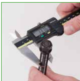
a Измерить диаметр шпинделя
