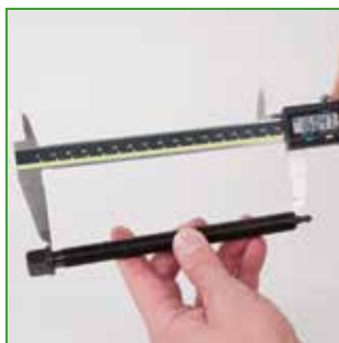
b Измерить длину резьбы до наконечника шпинделя.
