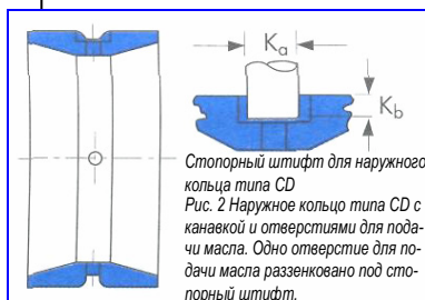
Рис. 1 Наружное кольцо, обозначаемое суффиксом D, с канавкой и отверстиями для подачи масла
