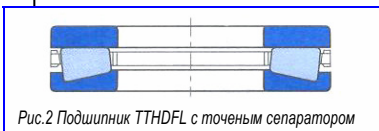
Рис.2 Подшипник ТТНДФЛ с точеным сепаратором
